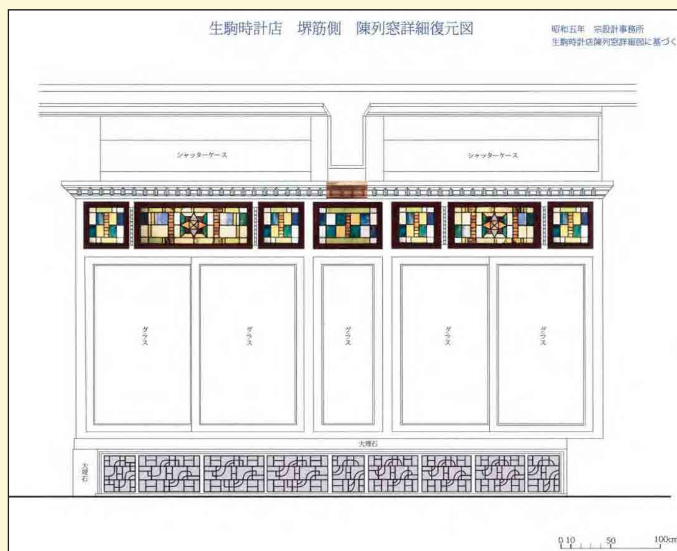
昭和5年宗設計事務所 生駒時計店陳列窓詳細図に基づく、堺筋側の陳列窓詳細復元図
